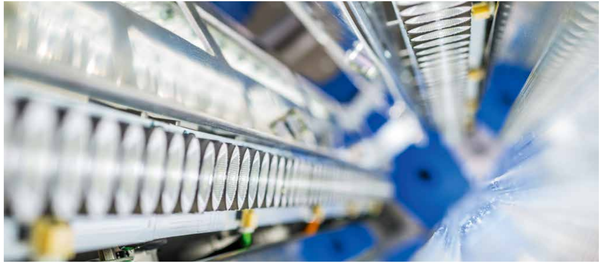
Im Detail: Eine LED-Beleuchtungseinheit im Fremtteilausscheider T-SCAN TS-T5 aus dem Hause Trützschler. Hier sorgen mehr als tausend LEDs mit zugeordneten Linsen für eine perfekte Ausleuchtung, mit deren Hilfe auch kleinste fadenförmige Fremtteile erkannt werden können. Foto: Trützschler
